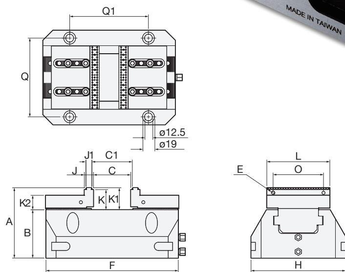
規格表 (材質: 本台工具鋼 S50C 滑軌經 HRC 50 热處理 / 夾持爪 工具鋼 SCM440 經 HRC 48-50 热處理) 單位: mm
